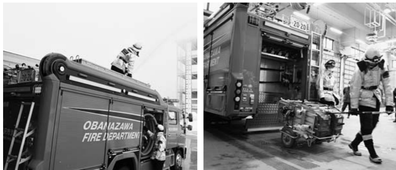
▲車両積載部に2,000ℓの水槽を搭載。車両上部には、高い場所や離れた場所への大量放水が行える放水銃も搭載されています。
