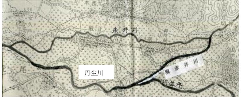
極めて近代的な河川(右図)で、川幅平均70mと広くとり、両岸を蛇籠(太い針金のかごに石を詰めたもの)で河川全域を護岸した。12ヶ所の堰堤は、急流による土砂の流出で河床が下がり、水田への取水が出来なくなるのを防ぐと共に水流を安定させるためのもの。6年の歳月をかけ昭和7年(1932)秋に完成した。宮沢の先人たちの素晴らしい行動力である。以後宮沢西部の水害は解消された。
