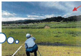
設置した構造物が基準の高さを確保しているか確認するため測量に立ち会います。
