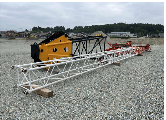
クローラークレーン部材。クレーンのアームの材料です。近くで見るととても大きいです。
