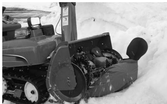
▲除雪機に巻き込まれる実験。(写真出典:NITE) 除雪機操作には特に注意が必要です。
