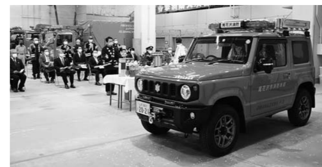
▲導入された車両には、緊急車両としての赤色回転灯、電子サイレン、無線機等のほか、災害時に必要な機材が積み込めるルーフラックや、車両後部に昇降はしごも設置されています。
