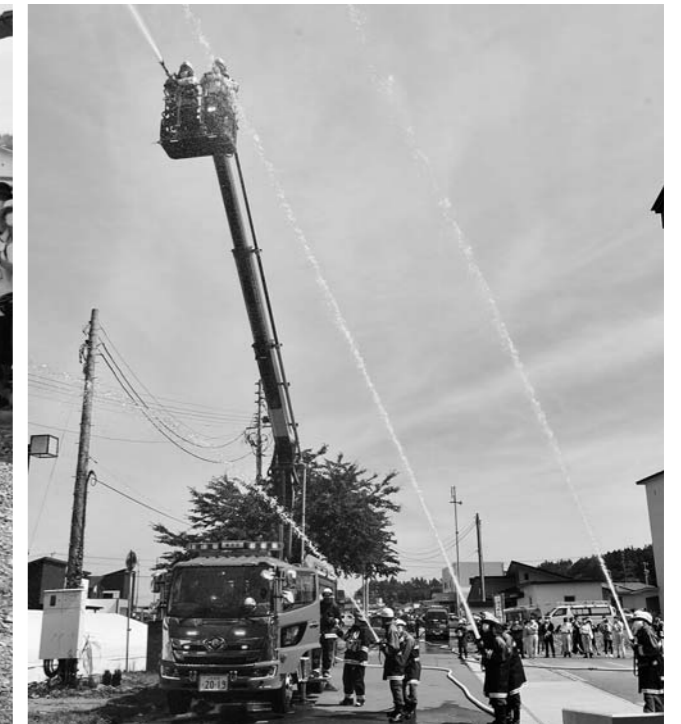
▲放水塔付消防ポンプ自動車の放水銃を使った、高所放水訓練。(尾花沢地区・荒橋市営住宅敷地内)
